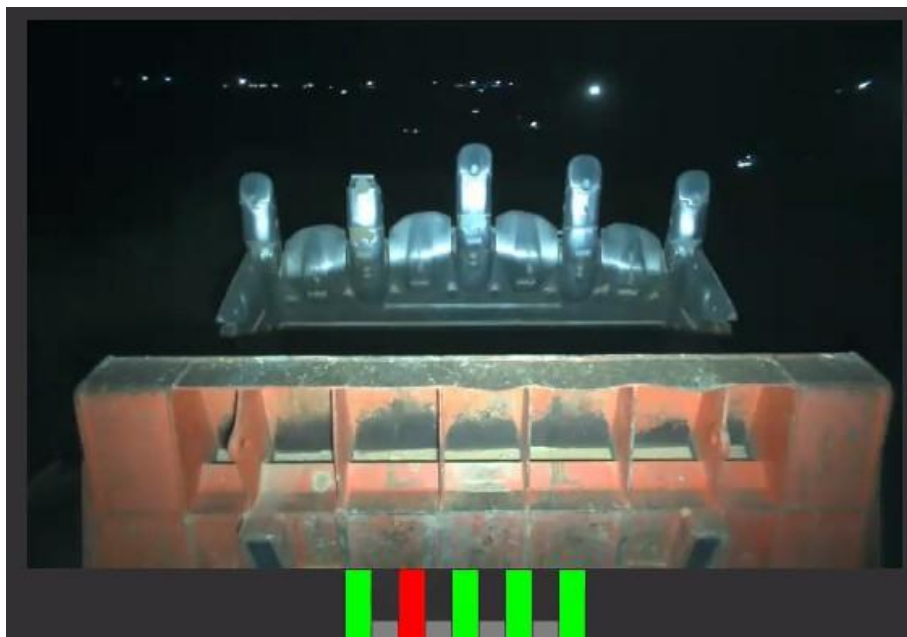
Рисунок 3.2. 5 Моментальне відображення відсутніх зубів ковша вночі
