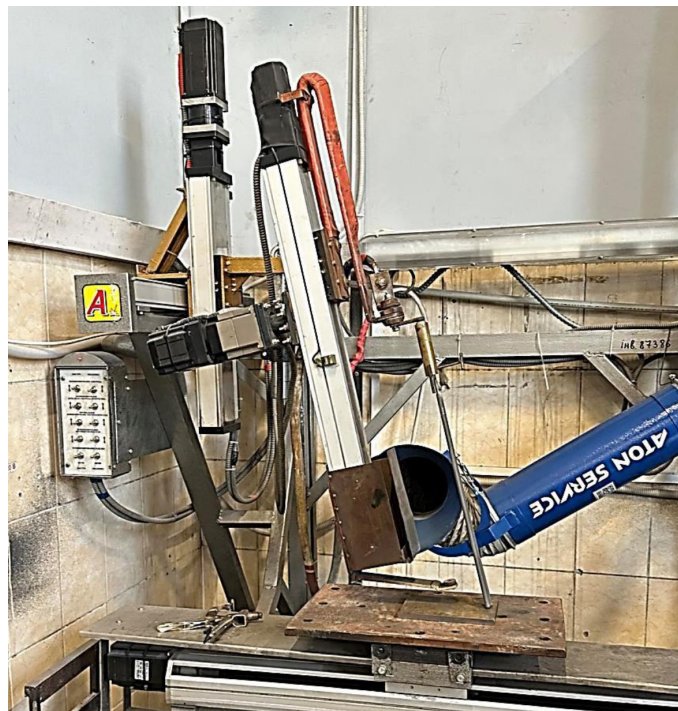
Рис. 1. Загальний вигляд (а) та робочий зварювальний стенд (б) дослідної установки УПЕ 500
