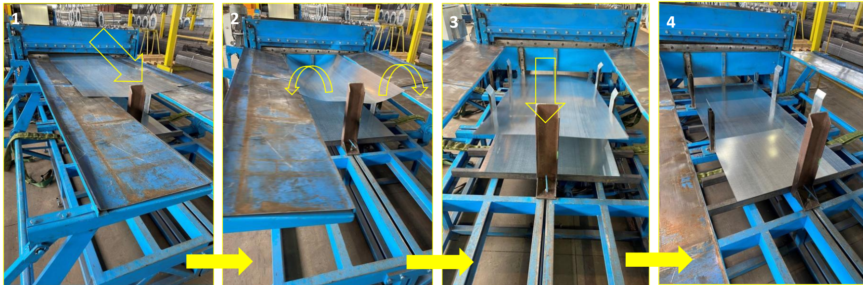
Рисунок 3.5 – Візуалізація суті запропонованого заходу модернізація приймального столу лінії поперечного різання рулонного металу.
