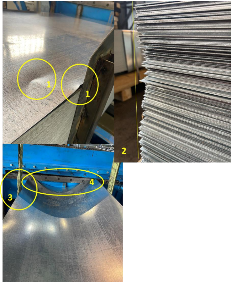
Рисунок 3.6 – Візуалізація суті запропонованого заходу модернізація приймального столу лінії поперечного різання рулонного металу.
