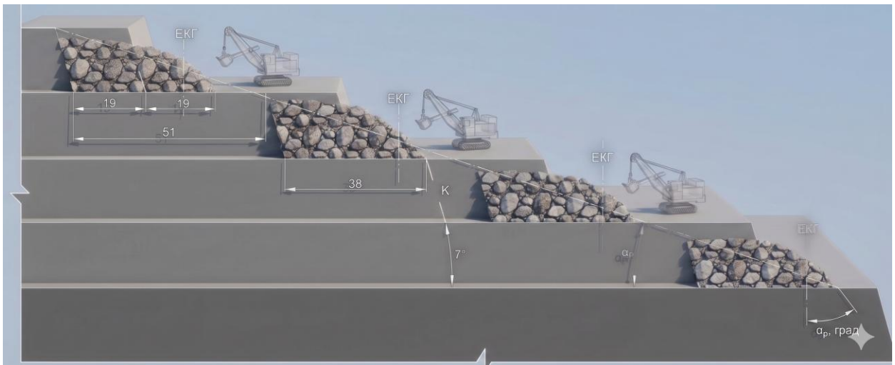
Рис. 2.4. Технологічні параметри розробки скельного масиву на уступах висотою h_y = 15 м із застосуванням мехлопат типу ЕКГ-10
