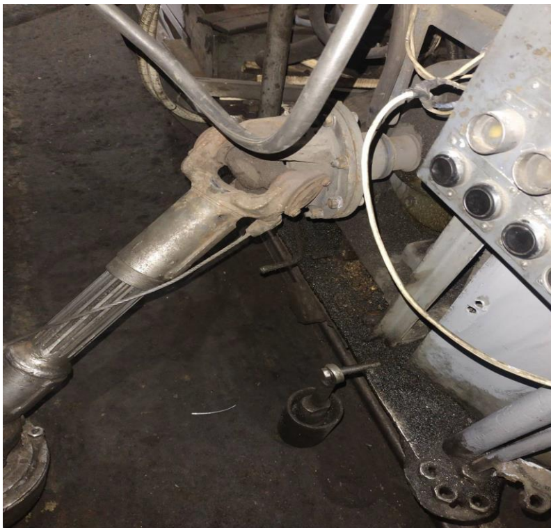
Рис.19 - Карданний вал приводу колісної пари
