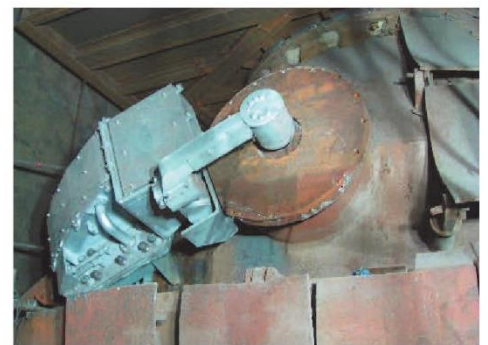
Рисунок 1.4 – Схема роботи пробкового стопора та його вигляд на льотці конвертера
