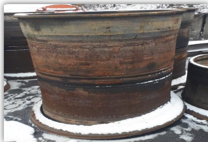
Рисунок 5.1 - Непридатний до експлуатації диск
