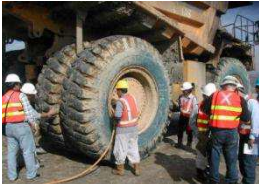
Рисунок 5.2 - Порушення правил накачування шини
