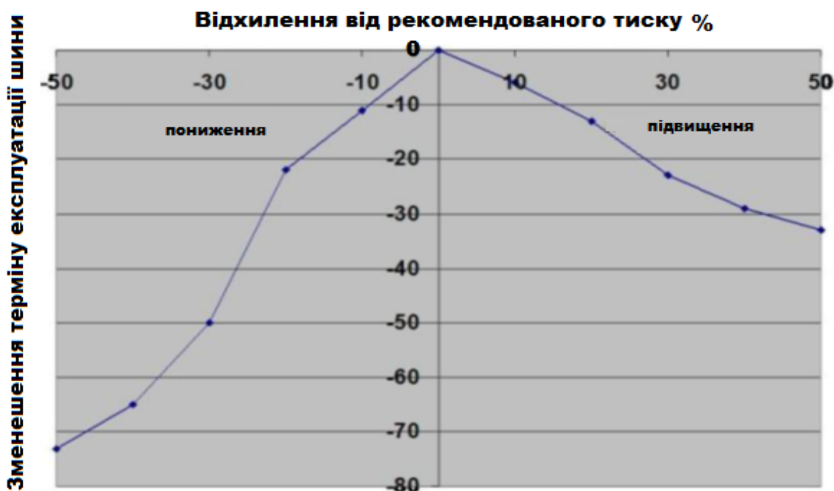
Рисунок 4.1 - Вплив тиску на ходимість шин
