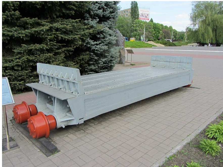
Рисунок А.9 – Візок випалювальної машини у музеї гірничої техніки ГЗК. Дані візки використовуються на в\м LURGI 552-A B
