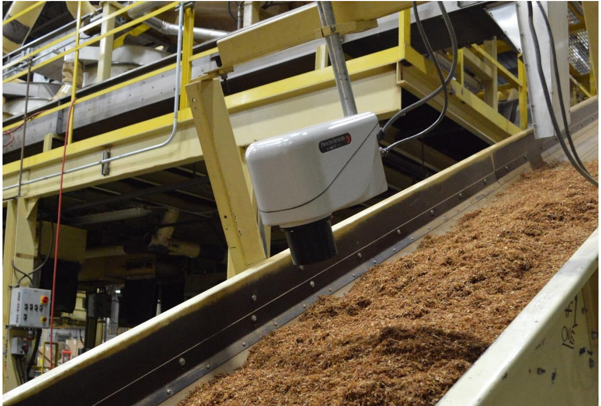
Рисунок 2.4 – Приклад застосування інфрачервоного методу вимірювання вологості
