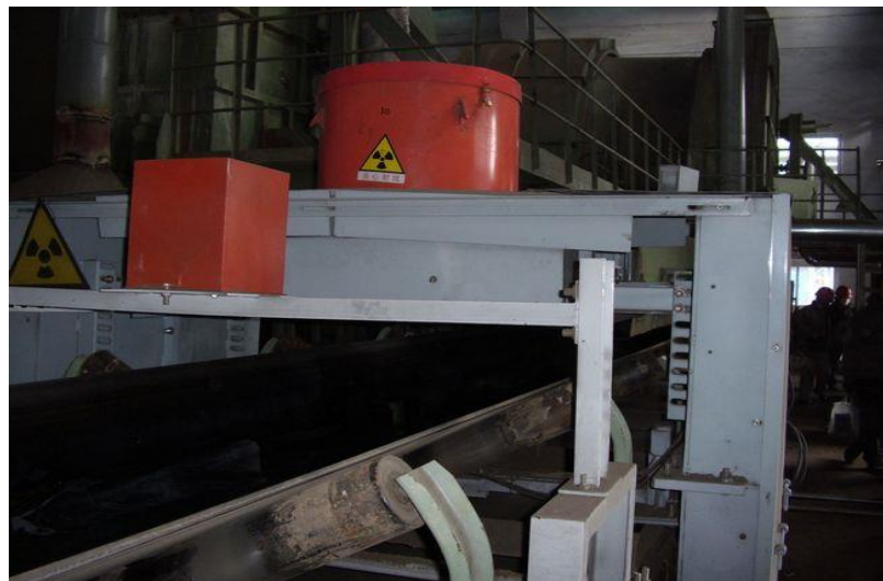
Рисунок 2.3 – Приклад застосування нейтронного методу вимірювання вологості
