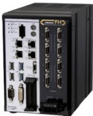
Рисунок 2.5 – а) камера високої роздільної здатності FH-SC04 та б) контролер обробки зображень FH-5552-20
