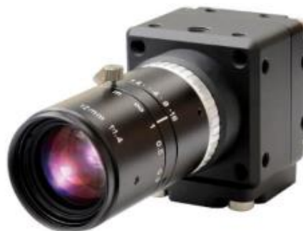
Рисунок 2.5 – а) камера високої роздільної здатності FH-SC04 та б) контролер обробки зображень FH-5552-20
