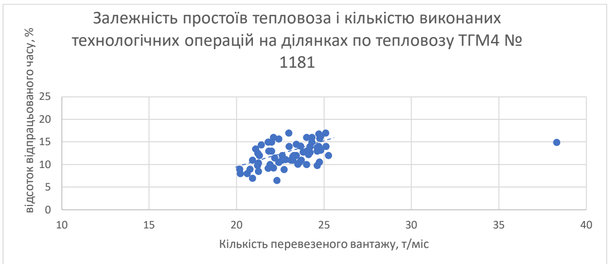
Рисунок 2.7- Крпкова діаграма залежності простоїв тепловоза і кількості виконаних технологічних операцій по ділянкам для тепловоза ТГМ4 № 1181
