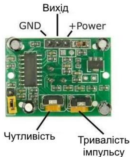
Рисунок 7.2 - Призначення контактів датчика руху HC-SR501
