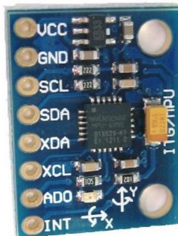
Рисунок 3.3 - Зовнішній вигляд модуля акселерометра-гіроскопа GY-521
