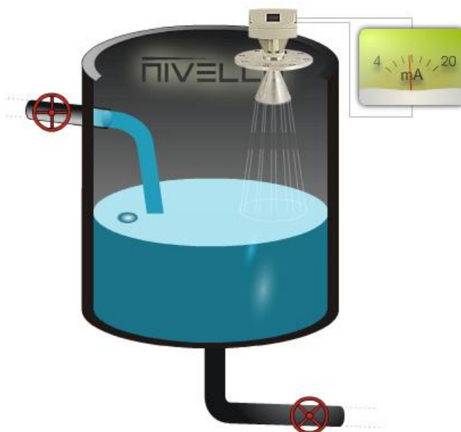
Рисунок 3.7 – Мікрохвильові радарні вимірювачі рівня
