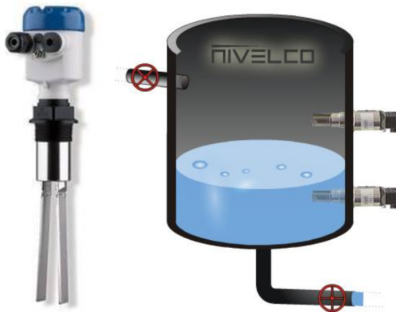
Рисунок 3.2 – Вібраційні датчики рівня
