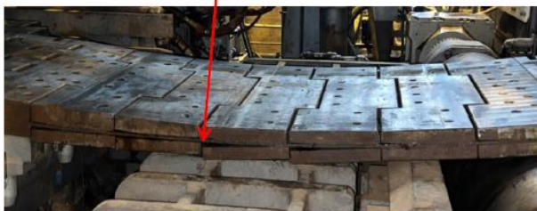
Рисунок 4.12. Затравка (Dummy Bar)
