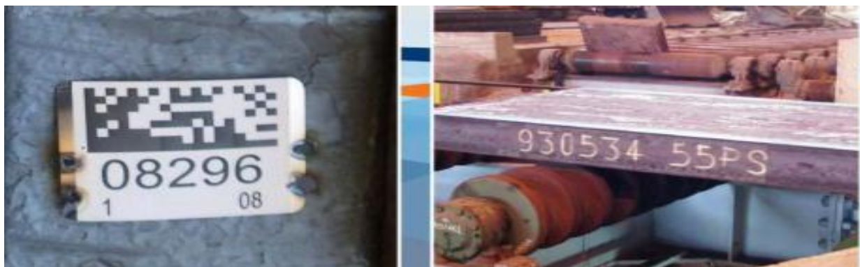
Рисунок 4.56 – Приклад маркування : штрих-код та нанесення порошку
