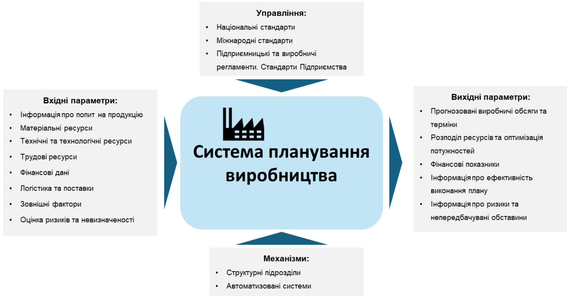
Рисунок 1.3 – Моделювання процесу планування виробництва black-box
