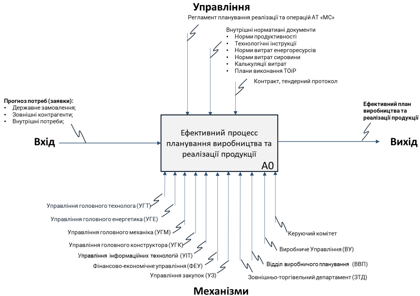
Рисунок 2.3 – Контекстна діаграма A0 бізнес-процесу планування виробництва «To be».
