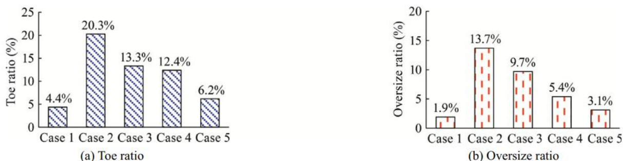
Рис. 1.4 – Аналіз якості проробки підшви уступу і виходу негабариту для свердловин різного діаметру [8]
