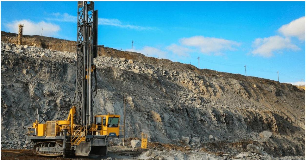
Рис. 2.3 – Верстат СБШ-250МНА на кар'єрі Інгuleцького ГЗК [17]
