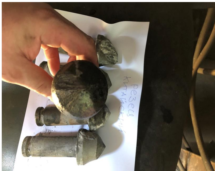
Рисунок 1.13 - Різець SJ 3222 після відпрацювання 10 п.м. на комбайні КСП-43 по простяганню пласта
