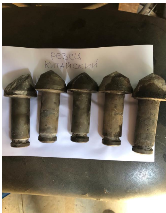
Рисунок 1.12 - Різець SJ 3222 після відпрацювання 10 п.м. на комбайні КСП-43 по простяганню пласта
