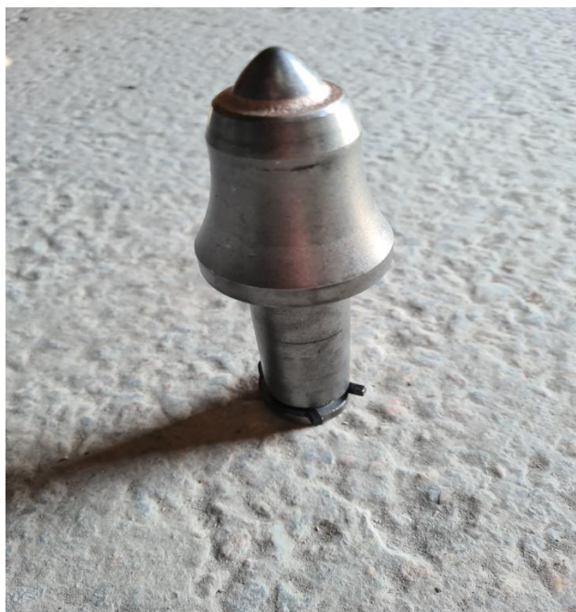
Рисунок 1.3 - Різці для проведення виробок по змішаному вибою – SJ3222
