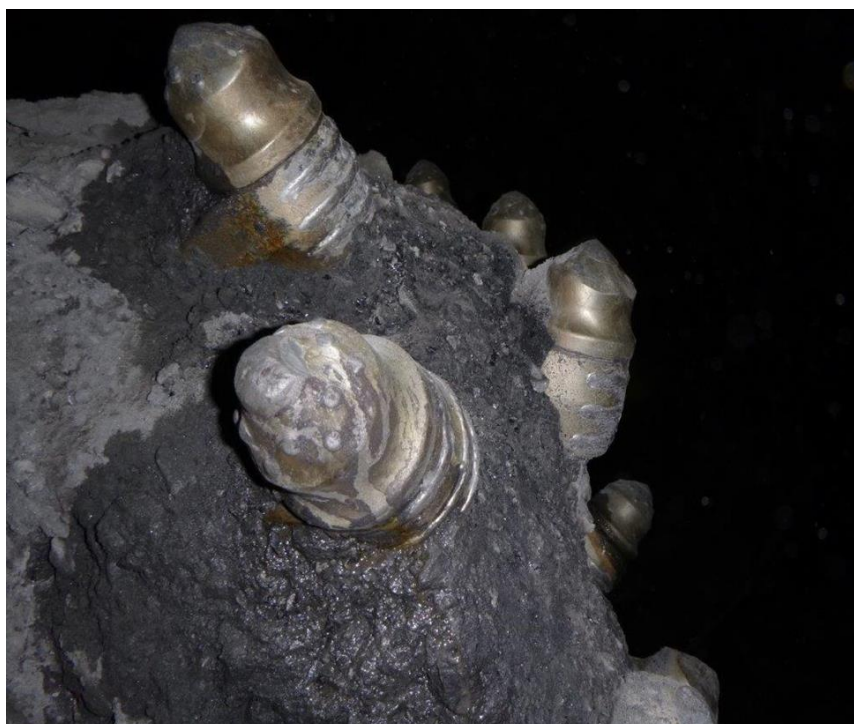
Рисунок 1.18 - Різець ARMOBIT 32.88.60.75 на короні комбайна П-315 після відпрацювання 10 п.м. по породному вибою
