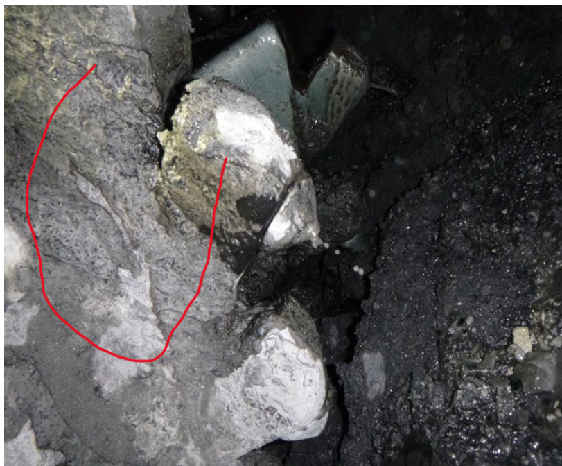
Рисунок 1.15 - Різець SJ 3222 на комбайні КСП-43 з відірваним різцетримачем
