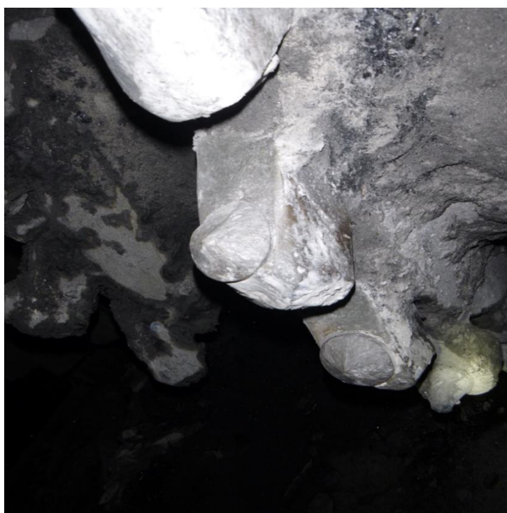
Рисунок 1.14 - Різець SJ 3222 після відпрацювання 10 п.м. на комбайні КСП-43 по простяганню пласта
