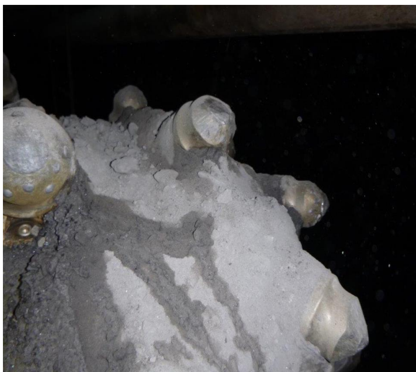
Рисунок 1.16 - Різець ARMOBIT 32.88.60.75 на короні комбайна П-315 після відпрацювання 10 п.м. по породному вибою
