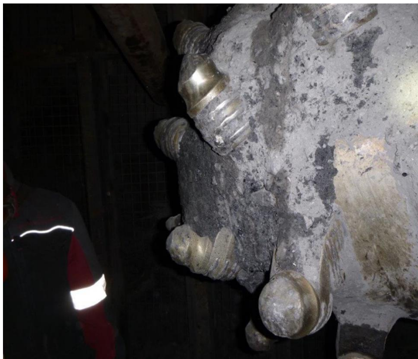
Рисунок 1.17 - Різець ARMOBIT 32.88.60.75 на короні комбайна П-315 після відпрацювання 10 п.м. по породному вибою
