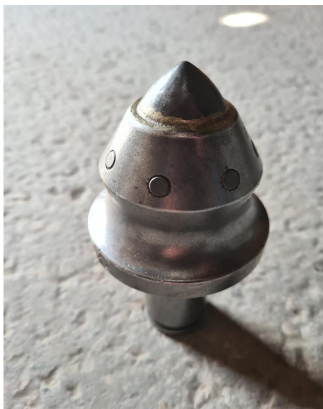
Рисунок 1.7 - Різець для проведення виробок по породному вибою - ARMOBIT 32.88.60.85
