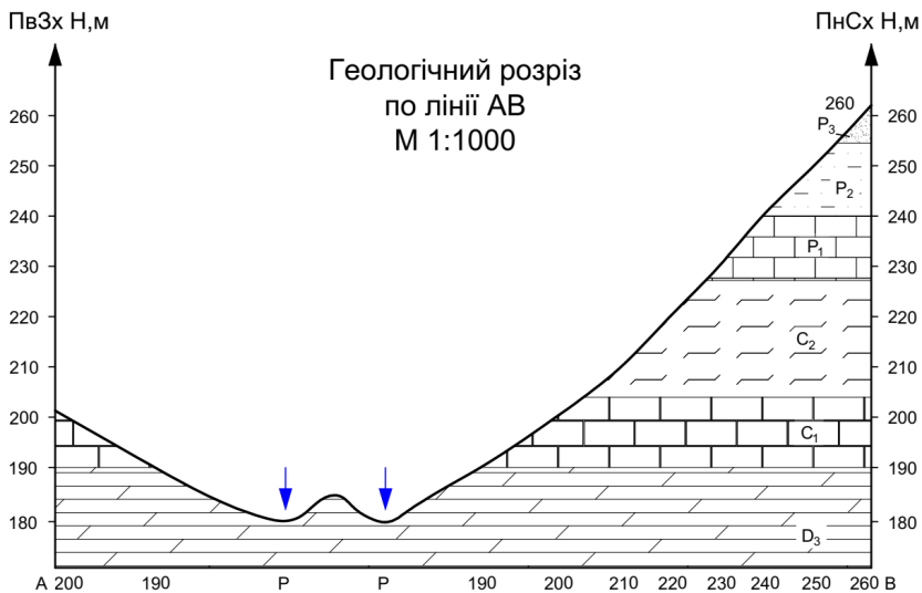
Рисунок 8.6 – Топографічний профіль та геологічний розріз за лінією АВ
