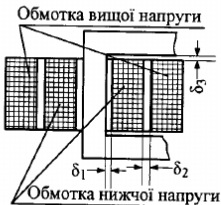
Рисунок 5.10 - Стрижень та ярма трансформатора з концентричними обмотками
