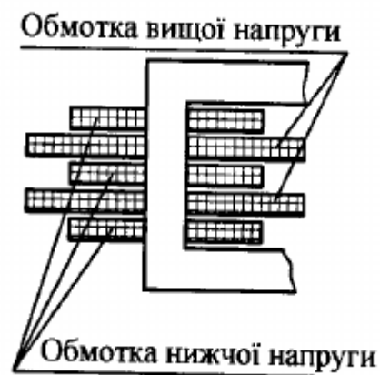
Рисунок 5.11 - Стрижень та ярма трансформатора з переміжними обмотками
