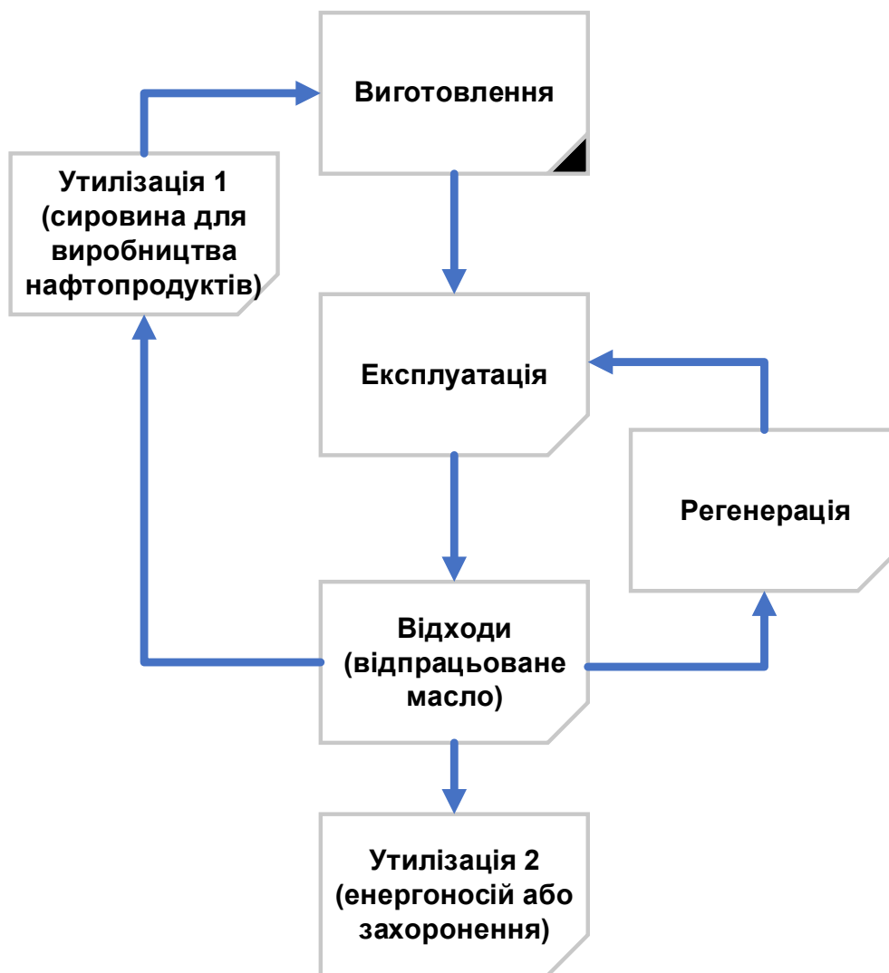
Рисунок 3.2 – Технологічний цикл енергетичних мастил та основні способи утилізації
