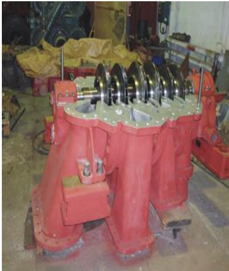
Рис. 2.1 - Ротор в проточній частині повітряного турбокомпресора К-525
