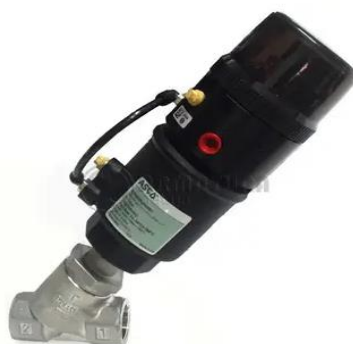
Рисунок 2.7 – Регулюючий клапан з позиціонером E290B048PDB67 DN20 PN10 ASCO Numatics керування 4-20 мА
