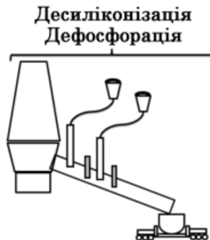
Рисунок 3.4 – Схематичне зображення технології ТІМ-процесу
