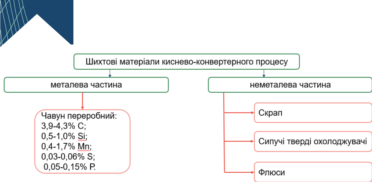
Рисунок 2.5 – Шихтові матеріали киснево-конвертерного процесу
