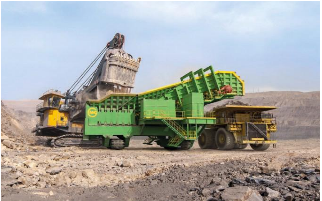
Рис. 2.2 – Екскаваторно-автомобільний комплекс із включеним до нього бункером-перевантажувачем [10]
