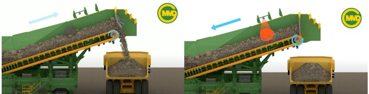
Рис. 2.6 – Принцип запобігання аварійних ситуацій при потраплянні негабариту [12]
