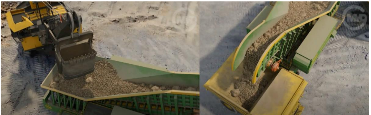
Рис. 2.5 – Завантаження гірничої маси у бункер за допомогою екскаватора [14]
