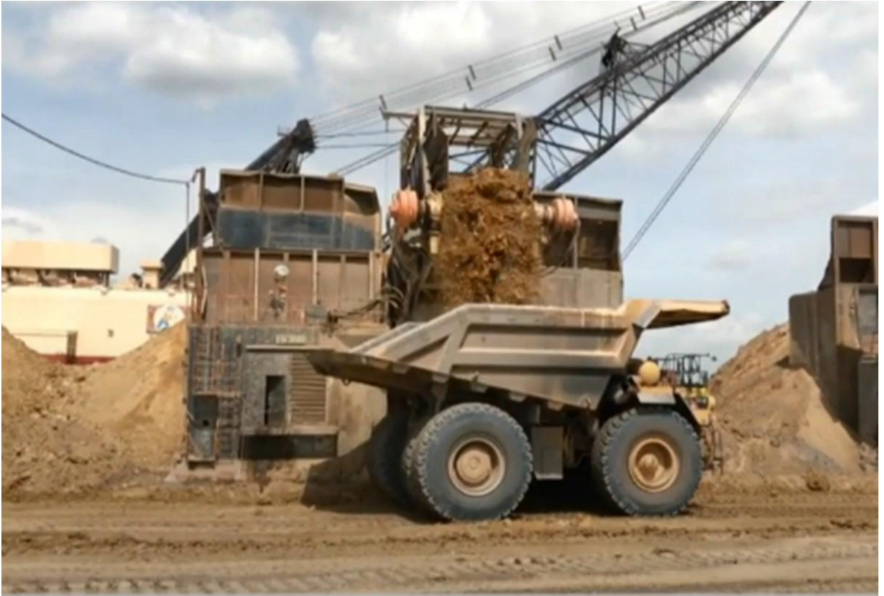
Рис. 2.3 – Процес експлуатації бункера-перевантажувача
