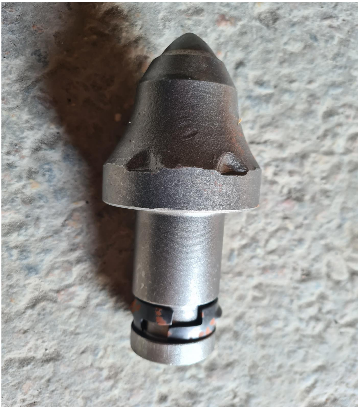
Рисунок 5.4. Різці для проведення виробок по змішаному вибою – BG32P-22.5570A
