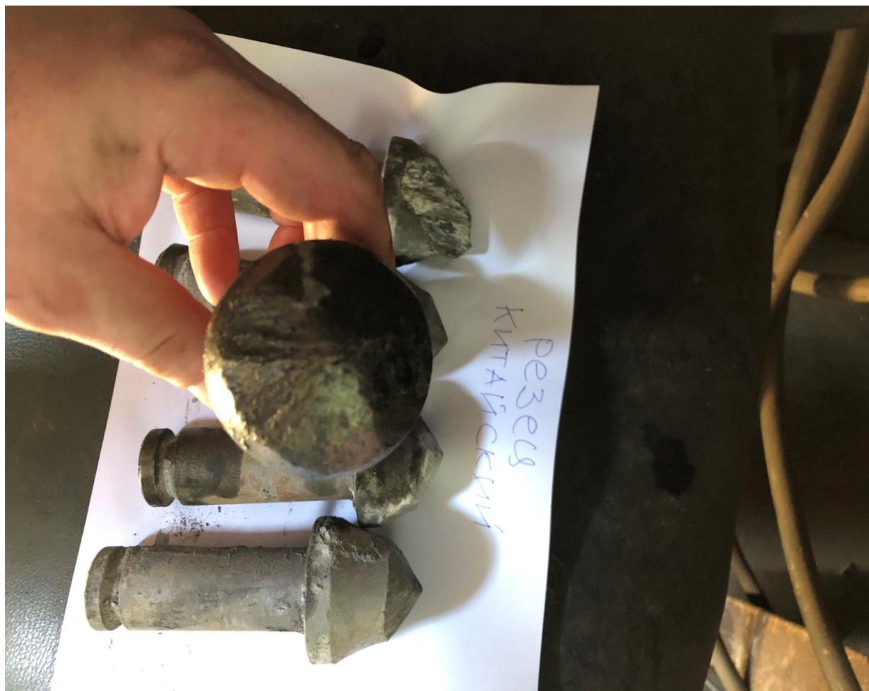
Рисунок 5.15. Різець SJ 3222 після відпрацювання 10 п.м. на комбайні КСП-43 по простяганню пласта
