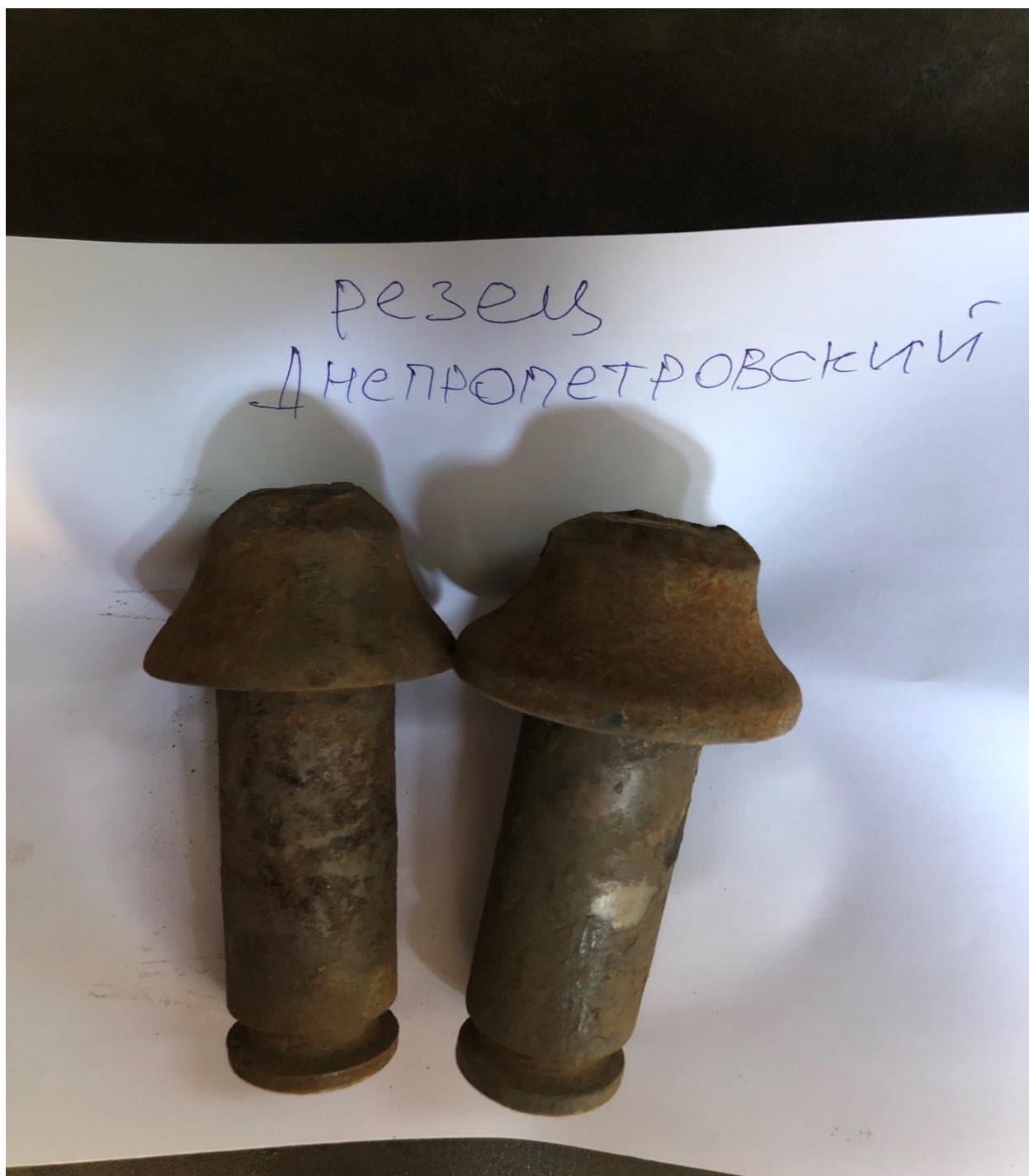
Рисунок 5.12. Різець РТМ 32.88.65.75 після відпрацювання 10 п.м. на комбайні КСП-43 по простяганню пласта
