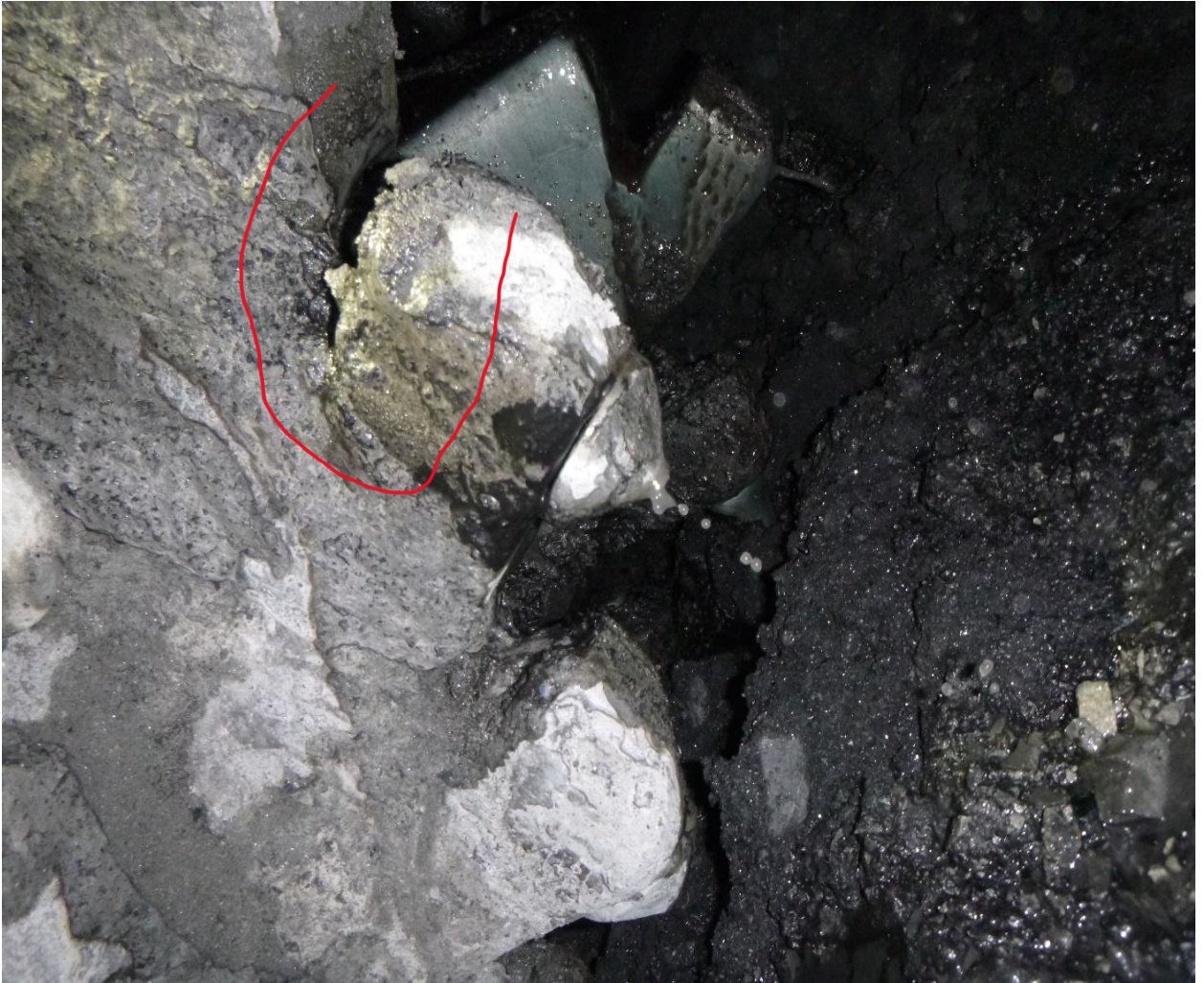
Рисунок 5.17. Різець SJ 3222 на комбайні КСП-43 відірваним різцетримачем
