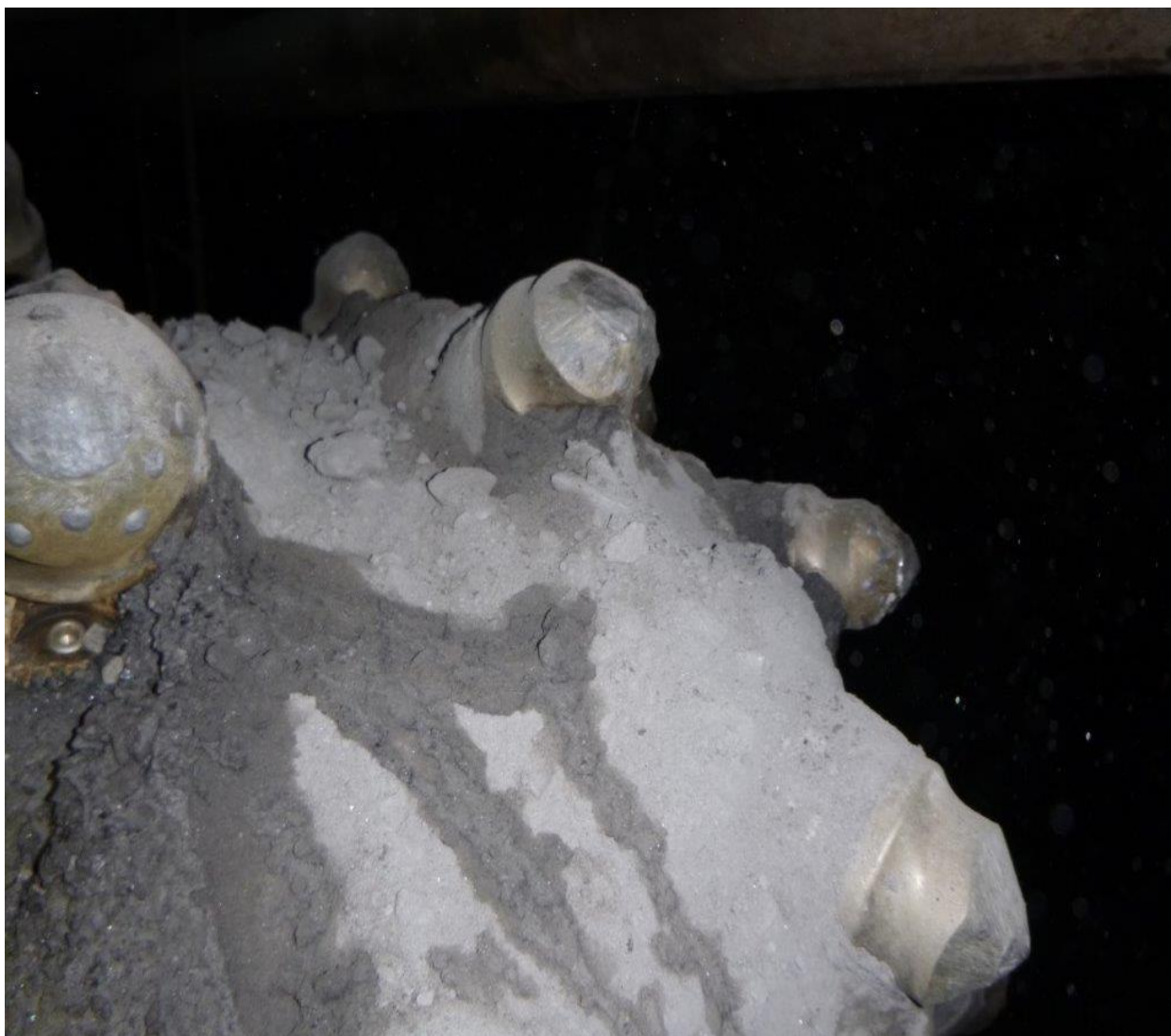
Рисунок 5.18. Різець ARMOBIT 32.88.60.75 на короні комбайна П-315 після відпрацювання 10 п.м. по породному вибою
