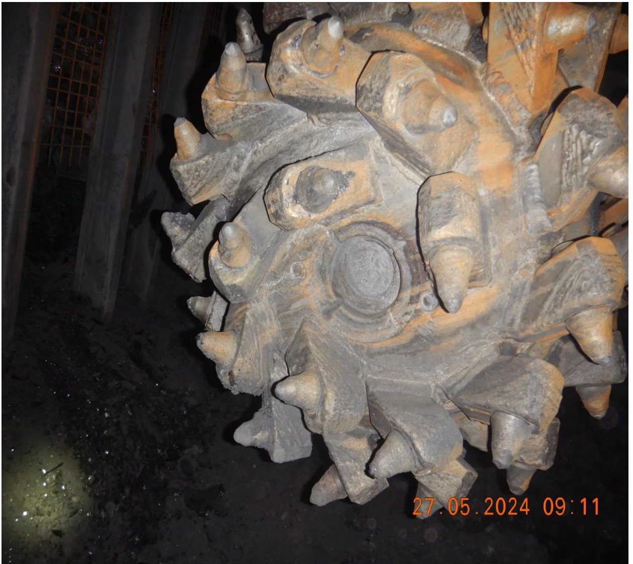
Рисунок 5.11. Корона КСП-43 с різцем РТМ 32.88.65.75
