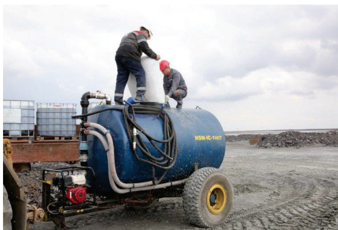
Рисунок 2.8 – Поливозрошувальні машини для нанесення [29]
