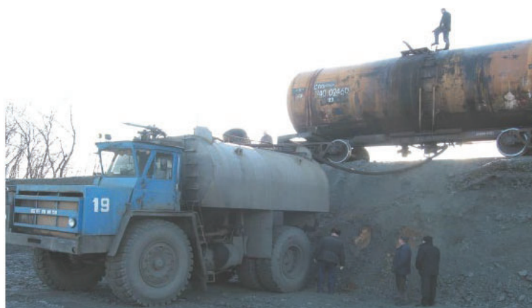
Рисунок 2.11 – Заправка гідромонітора бішофітом [7]
