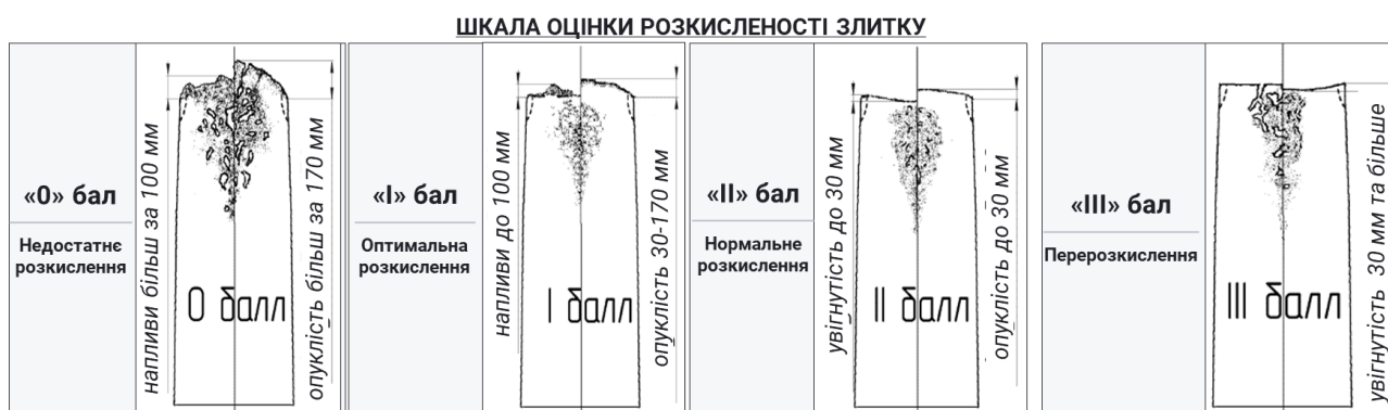
Рисунок 3.6 - Шкала оцінювання розкисленості злитків.
