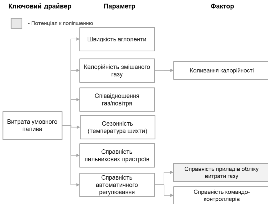
Рисунок 2.10 - Параметри та фактори що впливають на витрату умовного палива на запалювання шихти.
