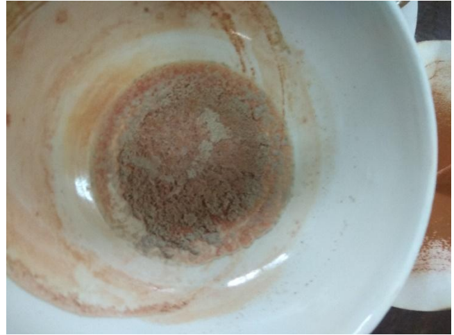
Рисунок 3 – Залізистий осад з джерельної води після випарювання
