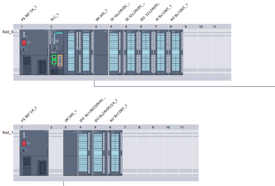
Рисунок 1.13 - Приклад конфігурування станції Simatic S7-300 з одною стойкою розширення з використанням модулі IM 365
