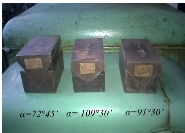
Рис. 1. Згинальні штампи з кутом підгину заготовки на \alpha = 72^{\circ}45' , \alpha = 109^{\circ}30' , \alpha = 91^{\circ}30'
