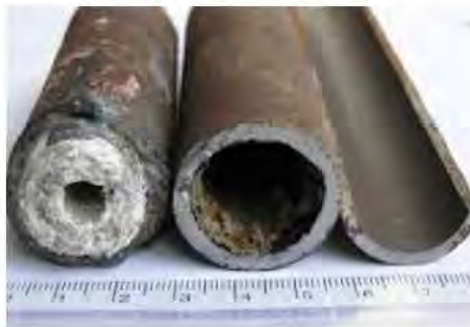
Рисунок 2.6 – Накип на стінках зміювика
