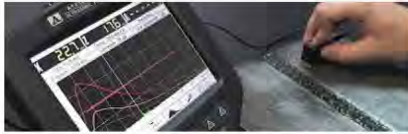
Рисунок 1.3 – УЗК зварних швів
