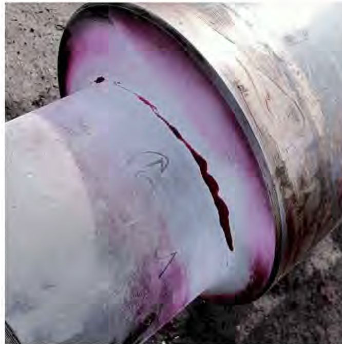
Рисунок – 1.6 Капілярний контроль
