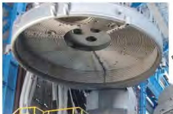
Рисунок 2.2 – Використання змійовиків для охолодження кришки електродугової печі
