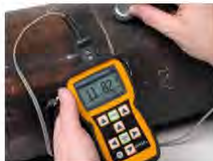
Рисунок 1.2 – Вимірювання товщини стінки труби за допомоги УЗТ
