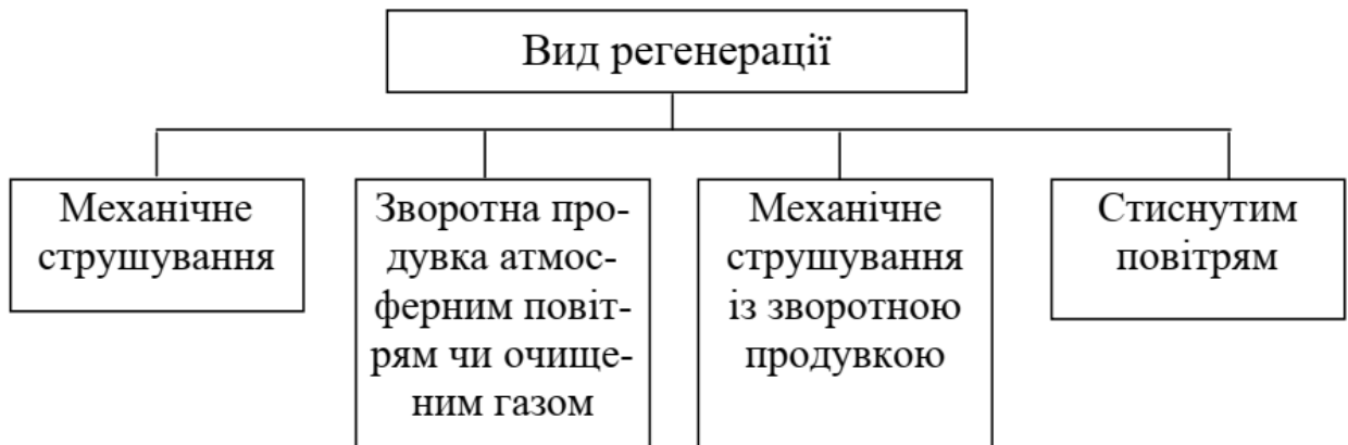
Рисунок 2.6 - Класифікація тканих фільтрів за видом регенерації
