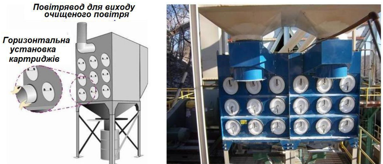
Рисунок 2.11 – Картриджний пиловловлювач із картриджами, що встановлюються горизонтально
