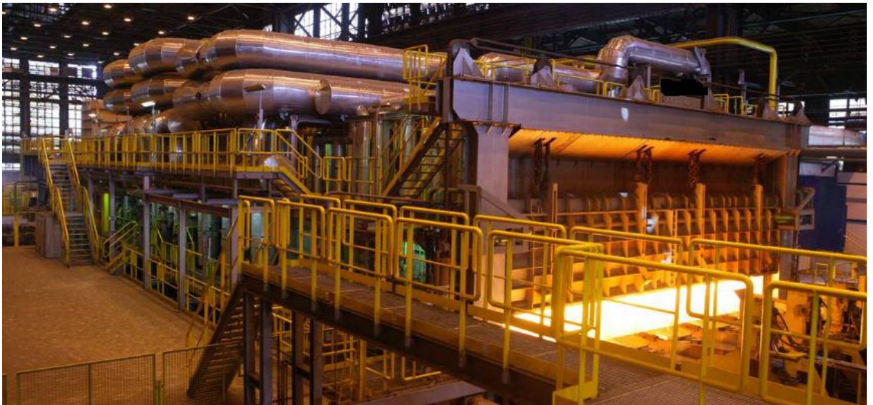
Рисунок 1.1 - Методична піч з крокуючими балками
