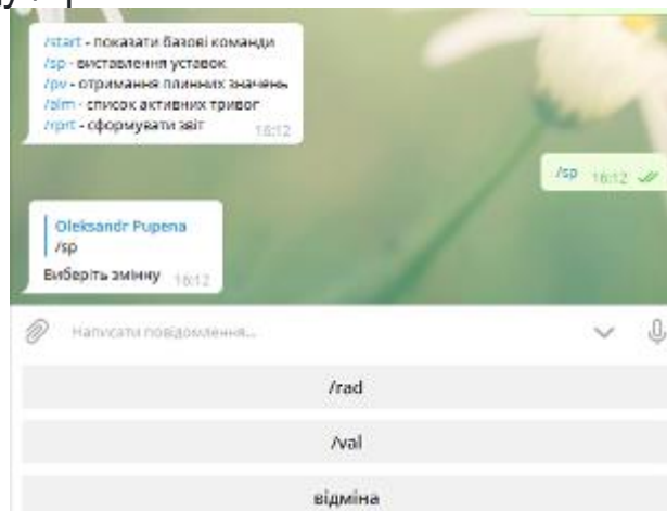
Рисунок 4.27 - Виставлення уставок – перевірка
