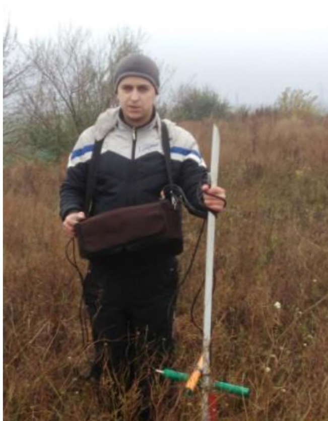
Рисунок 2. Оператор с прибором МИЭМП-14/4 с тремя антеннами
