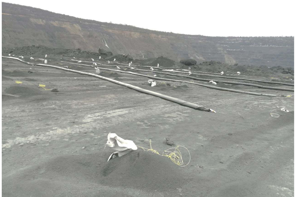
Рисунок 3.5 – Буровий блок із додатковою запірною забійкою в поліпропіленовому рукаві
