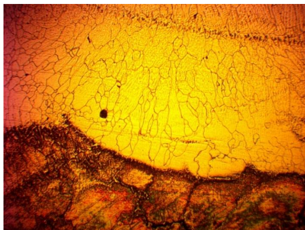
Рис. 3 – Мікроструктура межі сплавлення 100X8+110Г13Л (x200)
