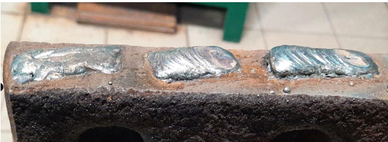
Рис. 1 – Загальний вигляд наплавлених валиків
