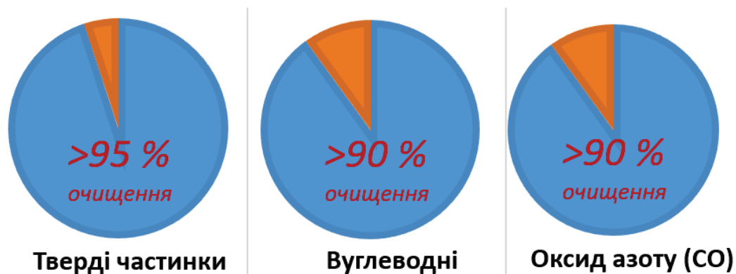
Рисунок 3.9 – Ефективність фільтрації забруднюючих речовин дизельним локомотивом [36]
