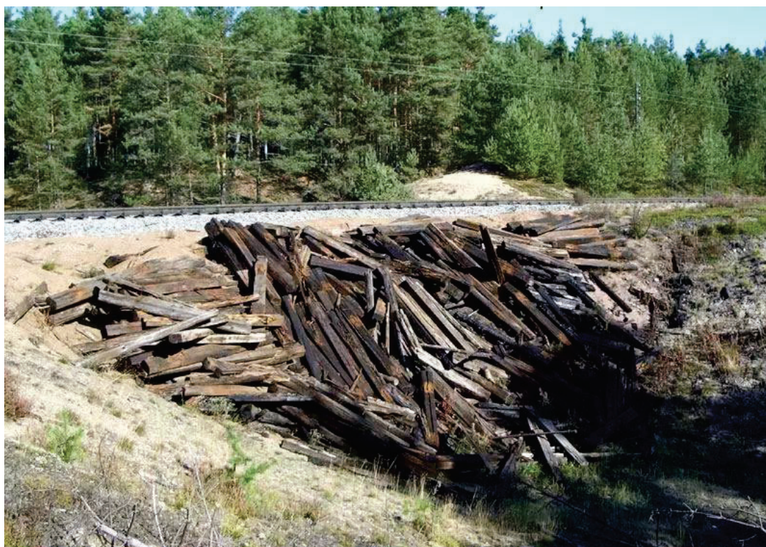
Рисунок 1.2 – Використані дерев'яні шпали, просочені креозотом [8]
