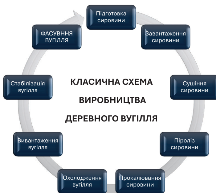
Рисунок 3.4 – Класична схема виробництва деревного вугілля [31]
