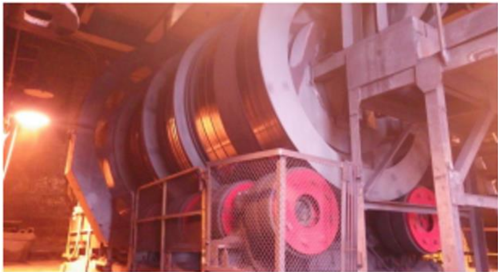
Рисунок 1.3 — Змішувальний барабан для підготовки агломераційної шихти
