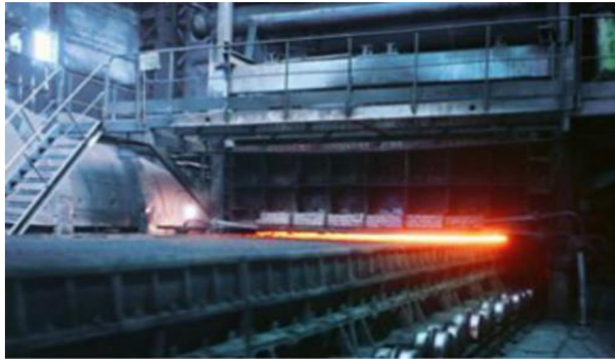
Рисунок 1.4 — Загальний вигляд працюючої агломераційної машини
