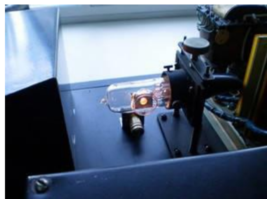
Рисунок 24 - Атомно-абсорбційний спектрофотометр з електротермічної атомізацією SEO-SPECTR S600
