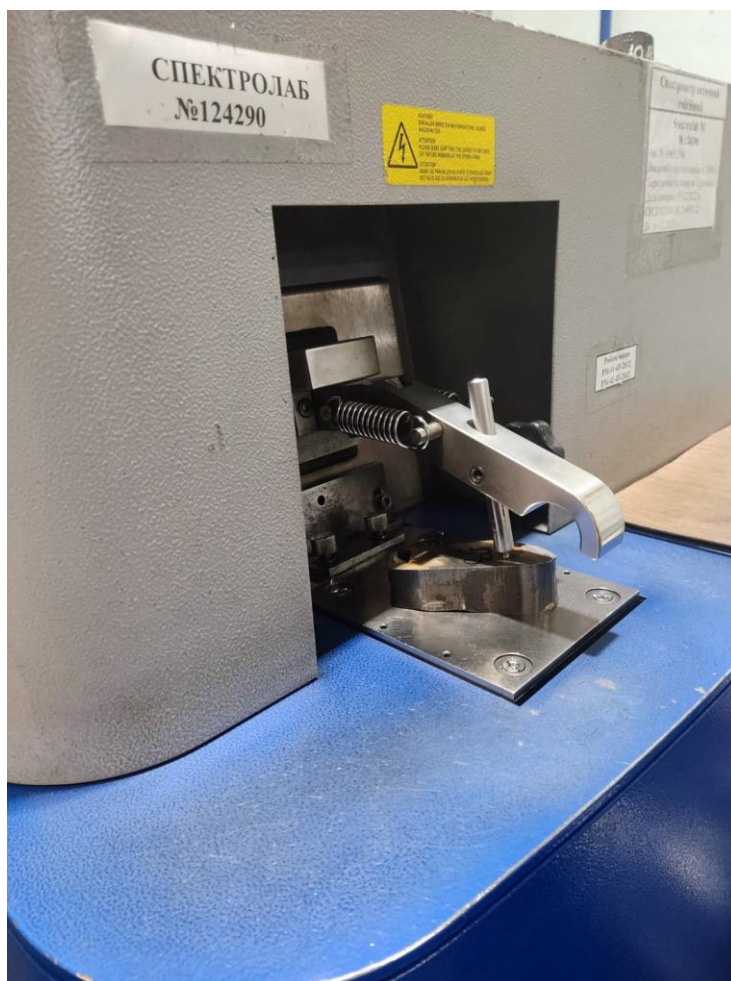
Рисунок 55 – Оптико-емісійний спектрометр SPECTROLAB M та зразок колісної пари.
