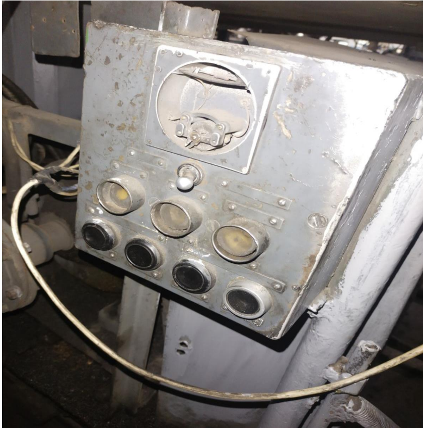
Рисунок 41 - Пульт керування механізмом протяжки.
