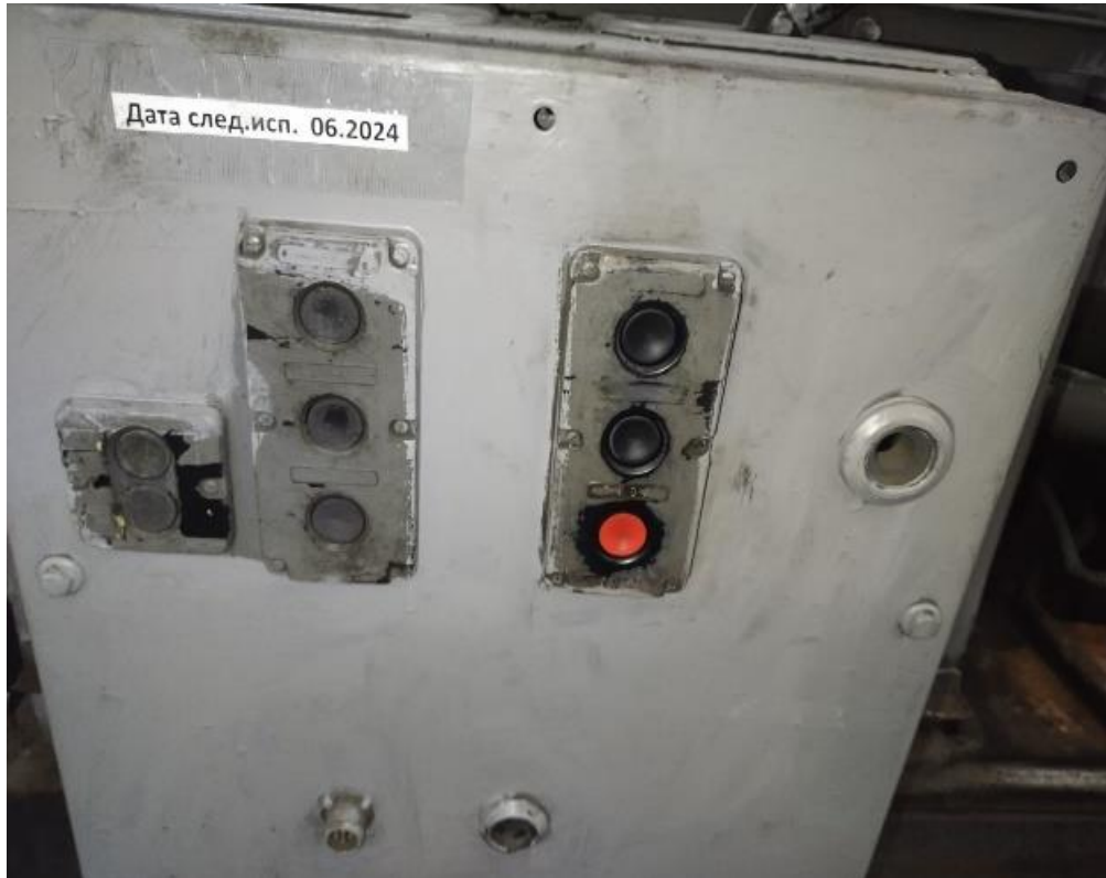
Рисунок 38 - Пульт керування візком наплавної установки
