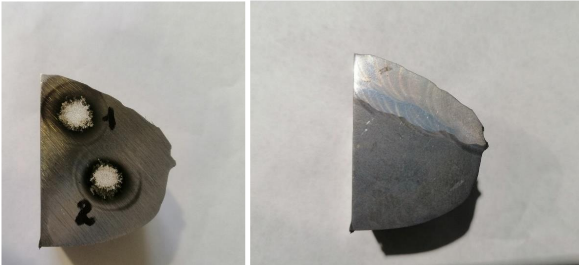
Рисунок 56 – Зразок гребня колісної пари, де 1 – наплавлений шар, 2 – основний метал
