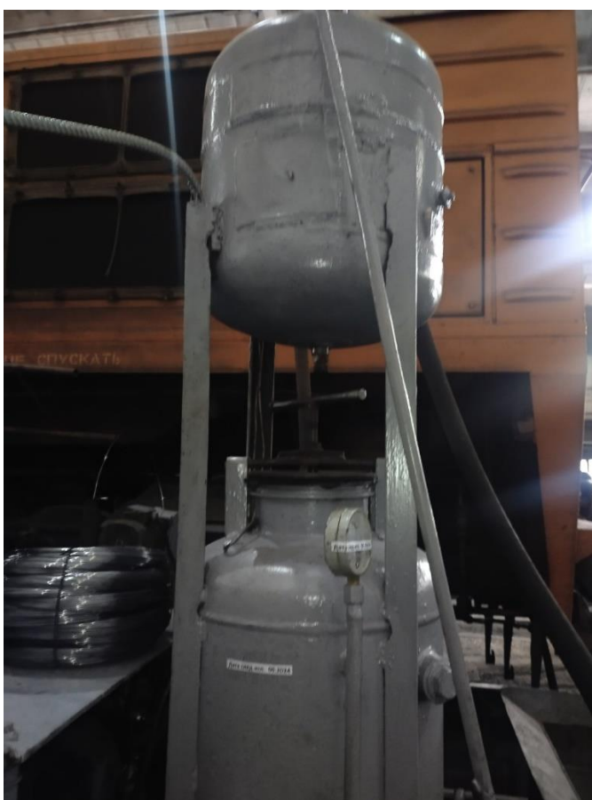
Рисунок 43 – Бункеры флюсового аппарата
