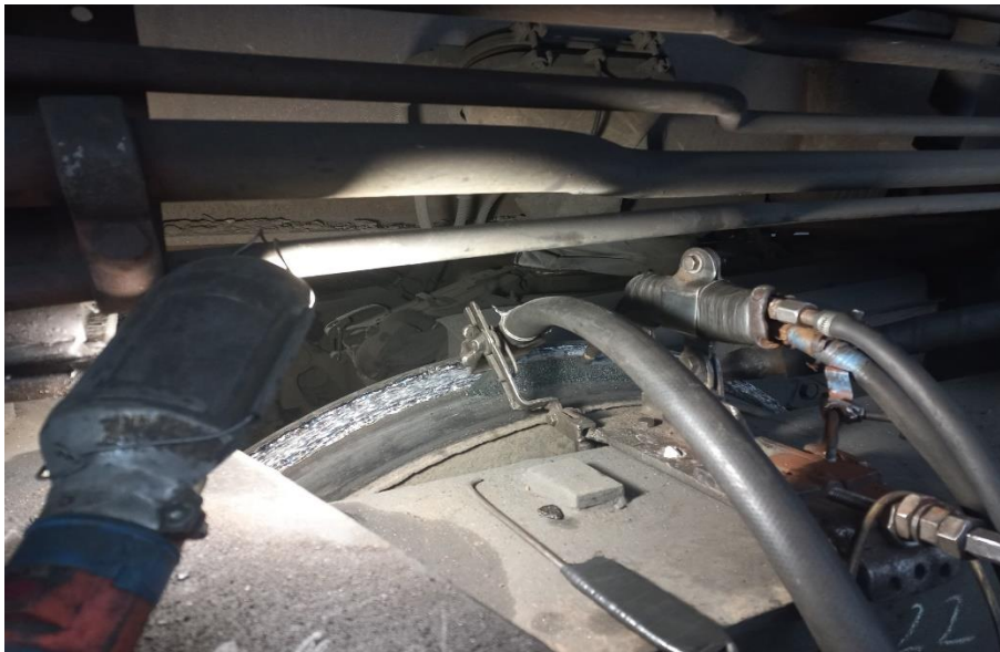
Рисунок 28 – Процес наплавлення колісної пари
