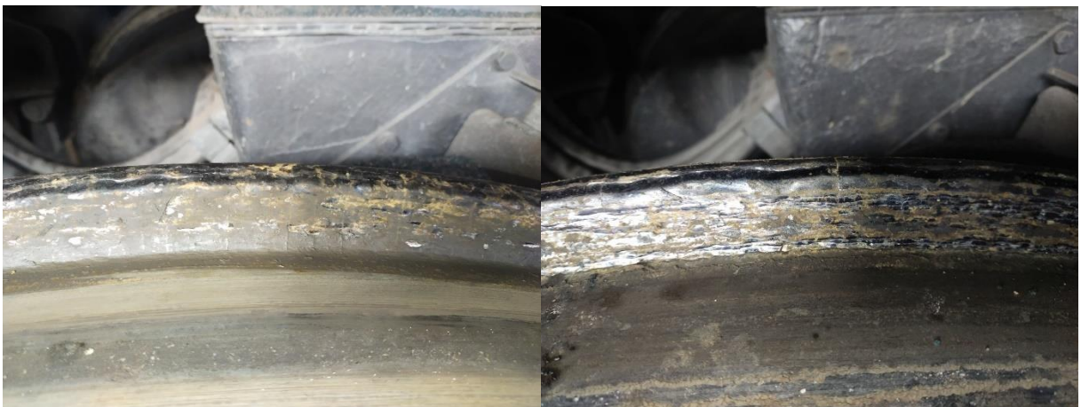
Рисунок 35 – Приклад задовільного зварного шву з явними мікротріщинами
