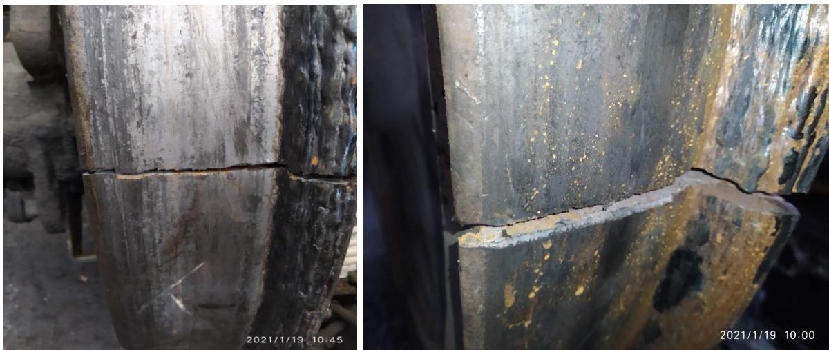
Рисунок 36 – наскрізне розтріскування бандажу колісної пари
