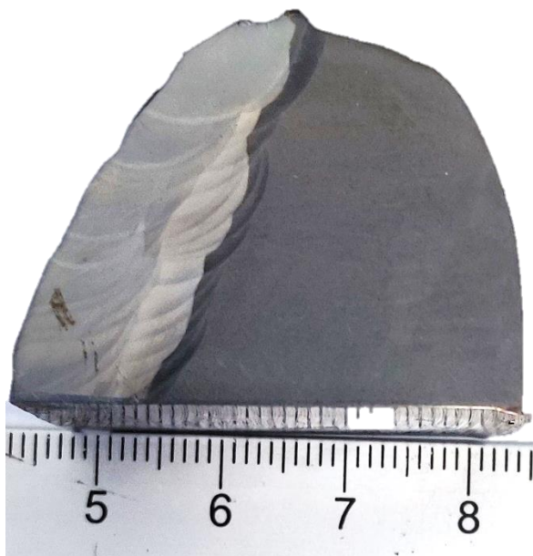
Рисунок 54 – Глибина наплавленого шару
