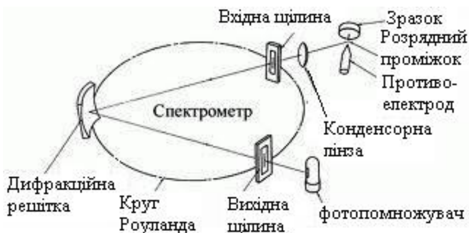
Рисунок 18 – Схема пристрою спектрометра з фотопомножувачем
