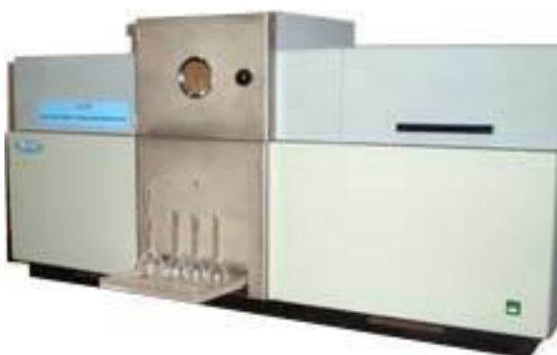
Рисунок 24 - Атомно-абсорбційний спектрофотометр з електротермічної атомізацією SEO-SPECTR S600
