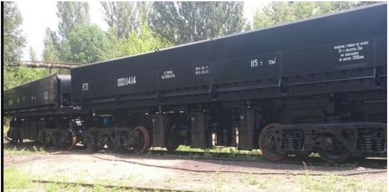
Рисунок 1.2 — Вагони-самоскиди 2BC105 у складі тягового агрегату
