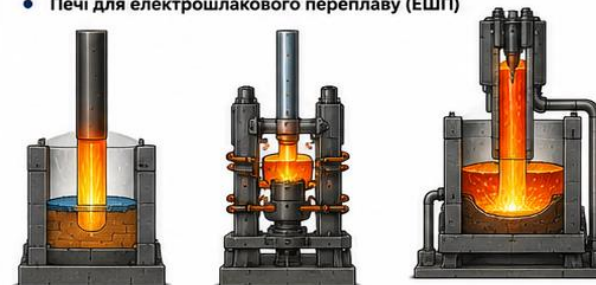
Рисунок 6 – Види електросталеплавильних агрегатів (зображення згенеровано ШІ): а – електродугова піч, б – індукційна піч, в – вакуумно-дугова піч, г – печі спеціального призначення
