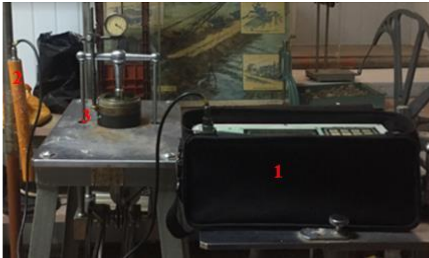
Рисунок 1 – Внешний вид прибора МИЭМП-14/4 (1) с вертикально расположенной принимающей антенной (2) во время одновременной фиксации ЭМИ и при нагружении образца глины на одомере (3)
