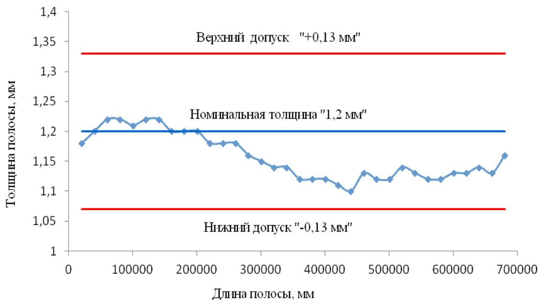
Рисунок 5.6 – График изменения средней толщины по длине полосы
