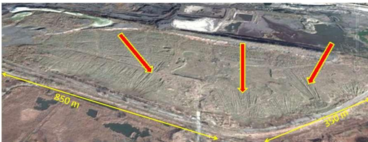
Рис 1. Лінійна ерозія на захисному екрані хвостосховища «Дніпровське». Стрілками показані промоїни, що утворилися по слідах бульдозера
