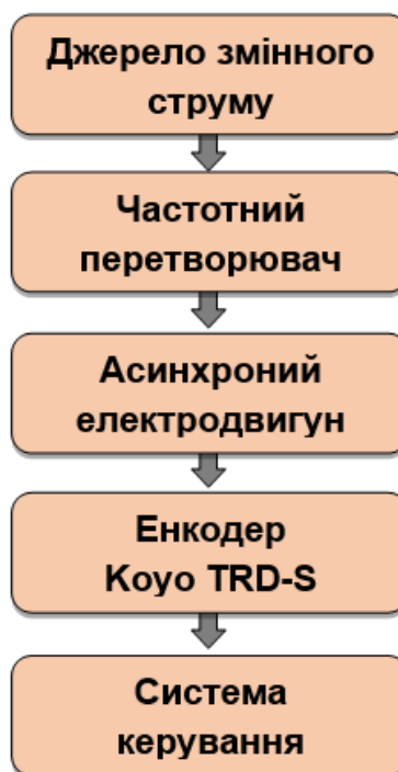
Рисунок 3.2 – Схема системи з використанням частотного перетворювача та енкодера Кою TRD-S
