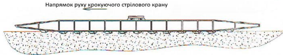
Рисунок 1.1 – Робота лижі крокуючих машин під час руху по щільному ґрунту
