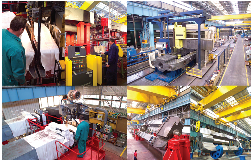
Рисунок 5.5 – Фрагменти процесу виготовлення зварної станини [15]
