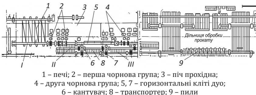
Рисунок 6.8 – Схема обладнання напівбезперервного крупносортового стану 600 [3]
