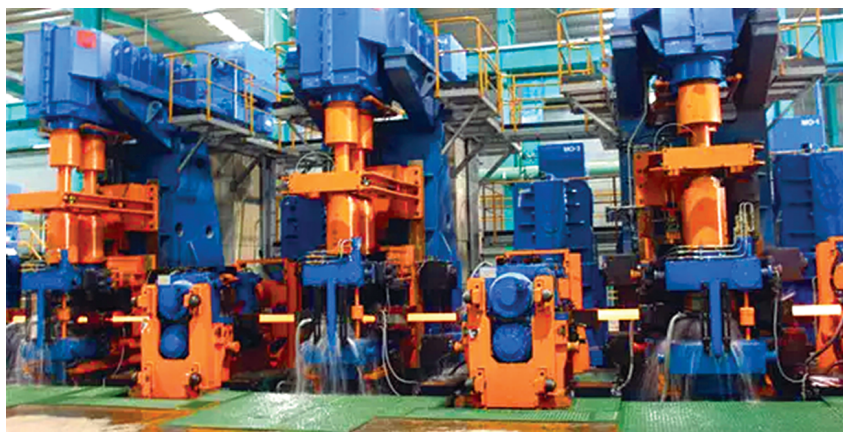
Рисунок 6.11 – Безперервна сортова група з горизонтальними і вертикальними робочими клітьми [18]
