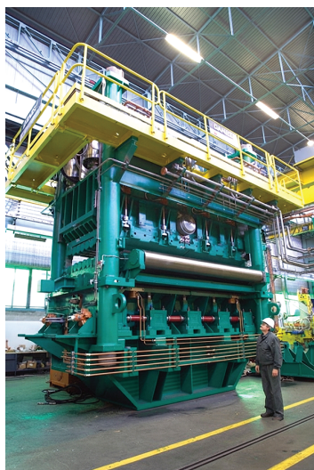
Рисунок 15.17 – Головна лінія машини листоправильної гарячої правки фірми Danieli [15]
