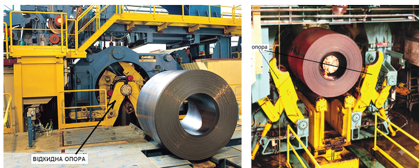
Рисунок 13.4 – Моталка з відкидною опорою: опора зведена ( a ); опора відкинута ( б ) [14]
