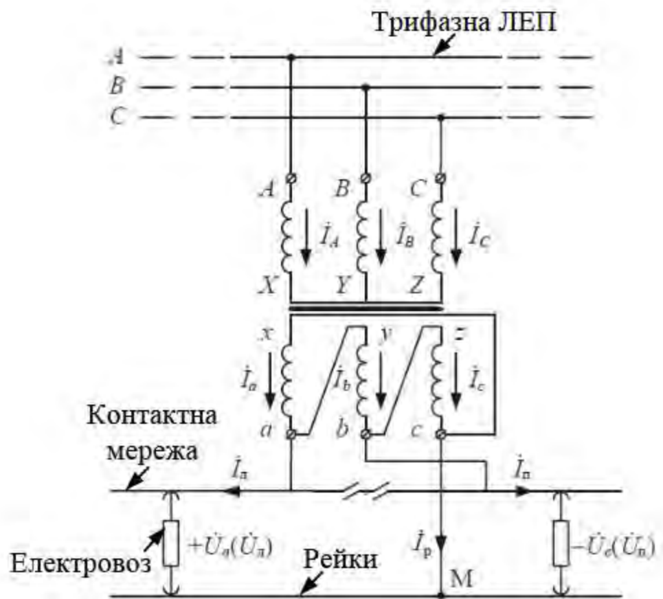
Рисунок 4.2 – Схема живлення тягової мережі однофазного струму за допомогою трифазного трансформатора зі схемою з'єднання Y/\Delta -11 (обмотка для живлення нетягового навантаження не зображена)
