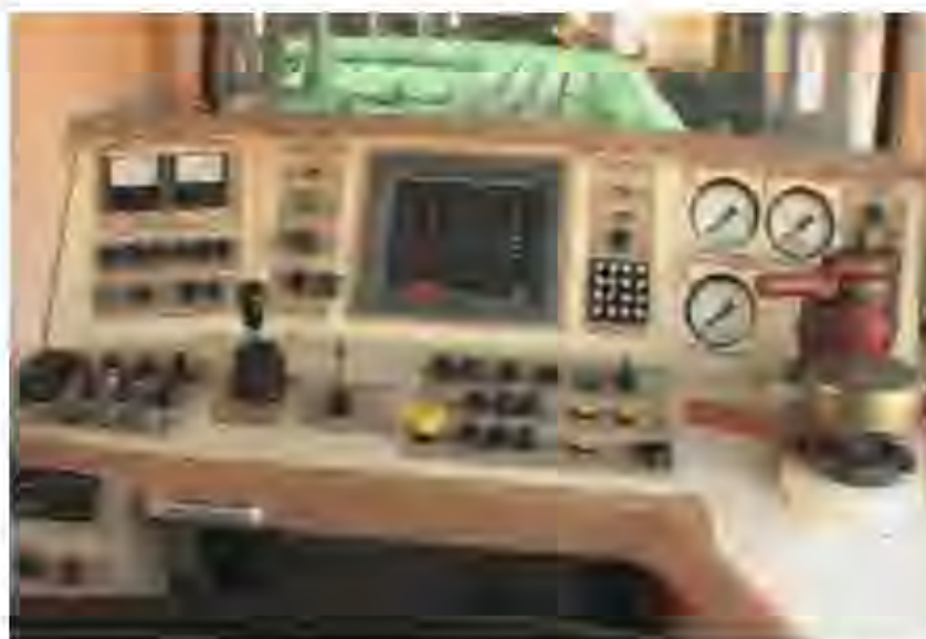
Рисунок 3.1 – Електронне обладнання в кабіні ОПЕ1АМ, для виконання всіх режимів експлуатації
