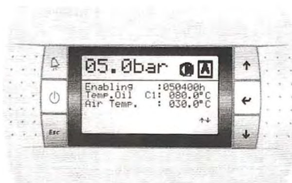
Рисунок 1.7 – Мікропроцесорний програмований пристрій управління компресором MAESTROx
