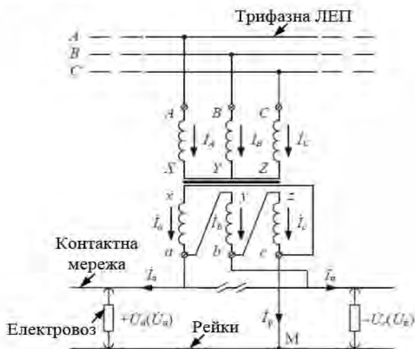
Рисунок 1.3 – Схема живлення тягової мережі однофазного струму за допомогою трифазного трансформатора
