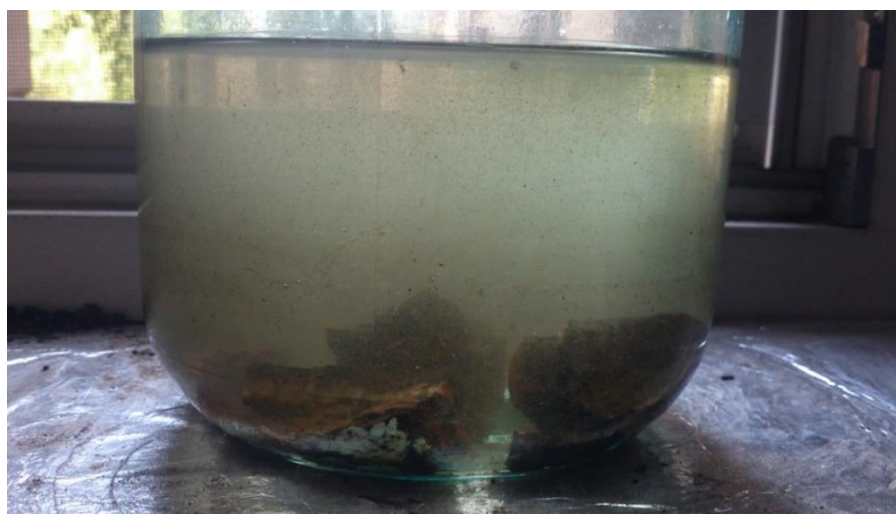
Рисунок 2.5 – Каламутний розчин після тривалого розчинення залізистих кварцитів, проба №2, вересень 2017 р.
