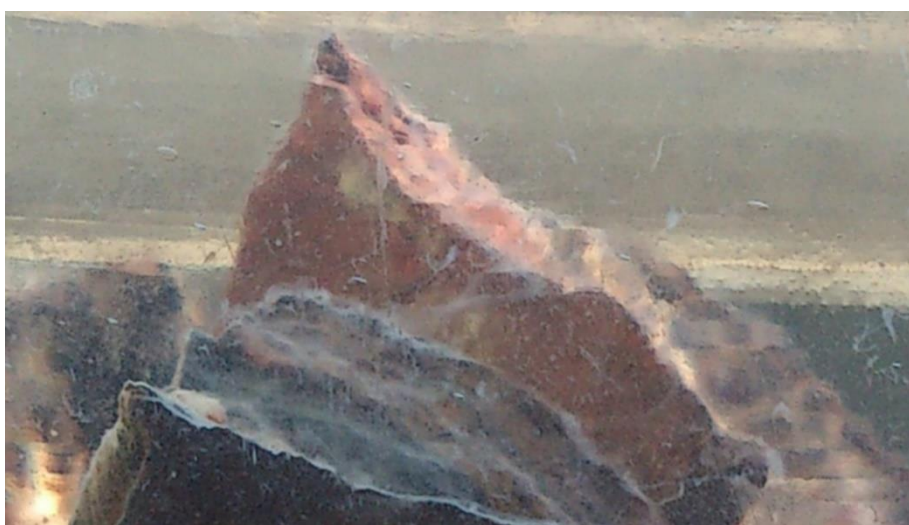
Рисунок 2.4 – Ниткоподібні утворення гелю кремнієвої кислоти під час розчинення залізистих кварцитів, проба №2, квітень, 2017 р.
