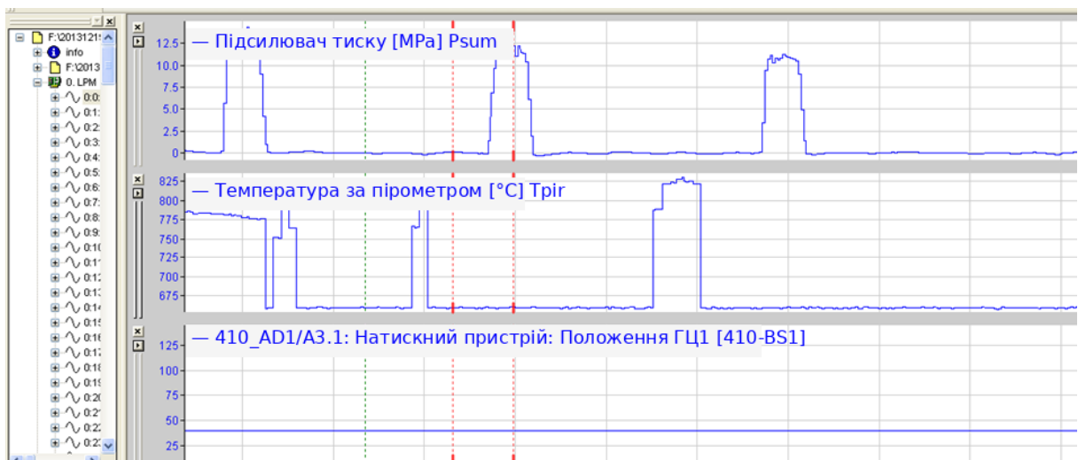
Рисунок 2.2 – Розподіл параметрів процесу правки на ЛПМ ТЛС 2850, відображені в системі ІВА
