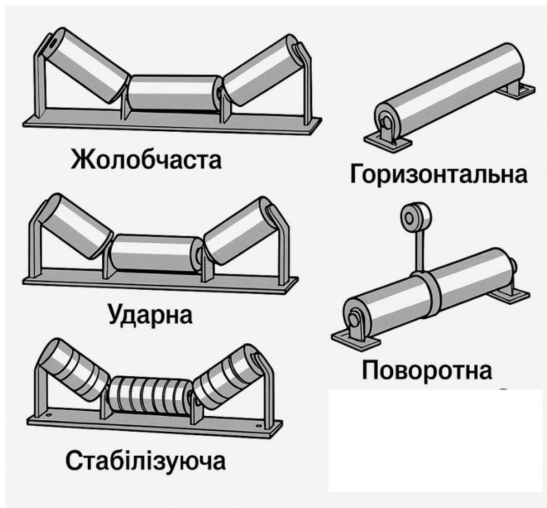
Рисунок 9.10 – Основні типи роликкоопор стрічкового конвеєра
