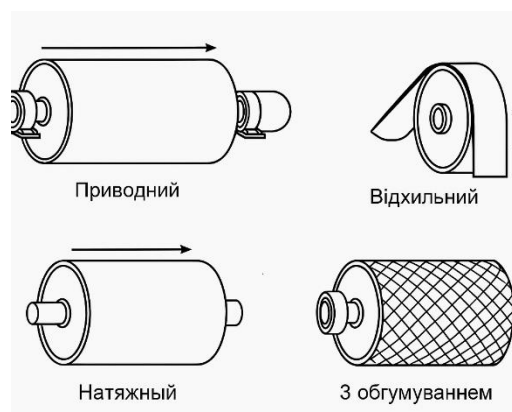
Рисунок 9.11 – Основні типи барабанів стрічкового конвеєра
